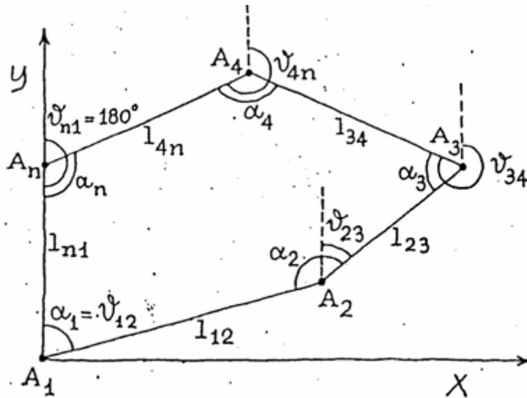
Ovviamente a causa degli errori di misura vi sara` una certa discordanza fra il valore teorico e quello misurato: questa differenza  $\epsilon$  dovra` rientrare nei limiti di tolleranza gia` fissati per la poligonale aperta. Per la compensazione si potranno correggere direttamente gli angoli misurati  $\alpha$ , ad ognuno dei quali sara` da apportare una correzione pari a  $\epsilon/n$ .
