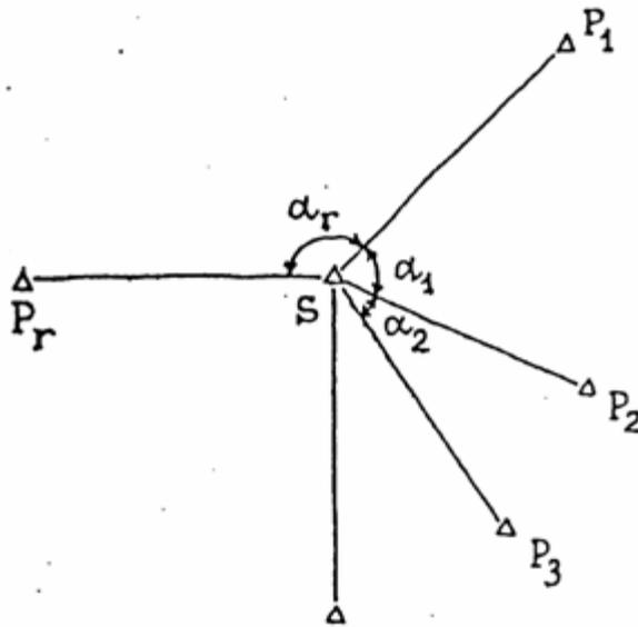
Consistente nel collimare due punti alla volta dal vertice S; si decide in base al tipo di precisione che si vuole conseguire, quante misure di uno stesso angolo si vogliono effettuare. Inoltre c'è bisogno di tre squadre, posizionate una sul teodolite e le altre due sulle due direzioni che individuano l'angolo da esse compreso. Si procede in questo modo:
