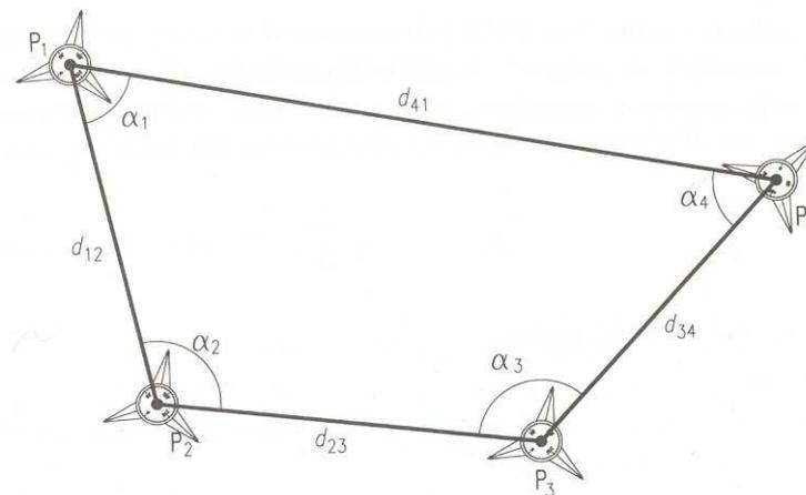
Tipologia del rilievo: IPERDETERMINATO in planimetria (3 volte)
