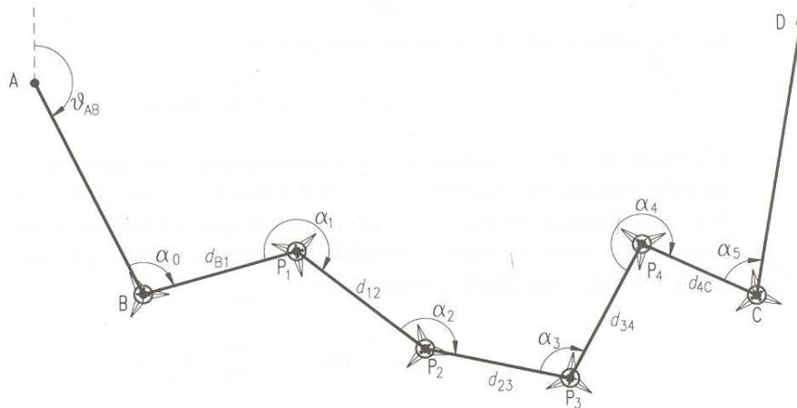
Tipologia del rilievo: IPERDETERMINATO in planimetria (3 volte)
