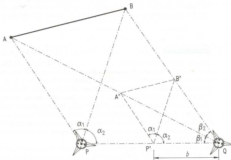
Tipologia del rilievo: ISODETERMINATO in planimetria, IPERDETERMINATO in quota.
