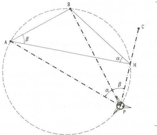
Tipologia del rilievo: ISODETERMINATO in planimetria, IPERDETERMINATO in quota.
