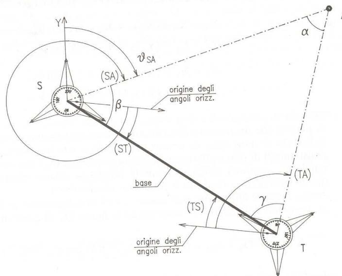
Tipologia del rilievo: ISODETERMINATO in planimetria, IPERDETERMINATO in quota
